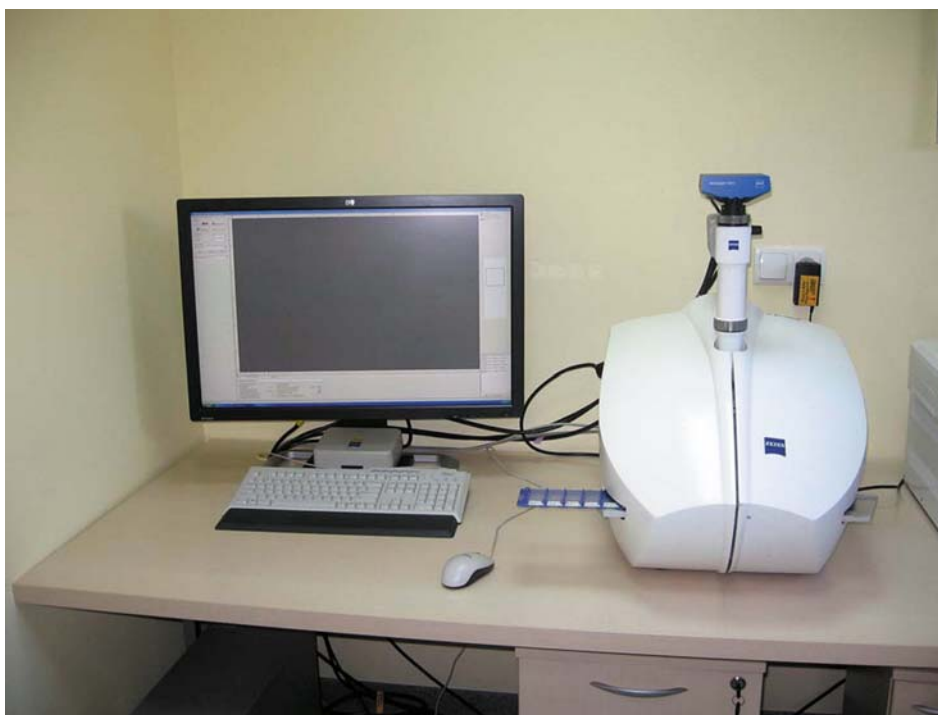
RYCINA 2. Skaner Mirax-Midi (Carl Zeiss) z zasobnikiem pozwalającym na automatyczne skanowanie 12 preparatów histologicznych
